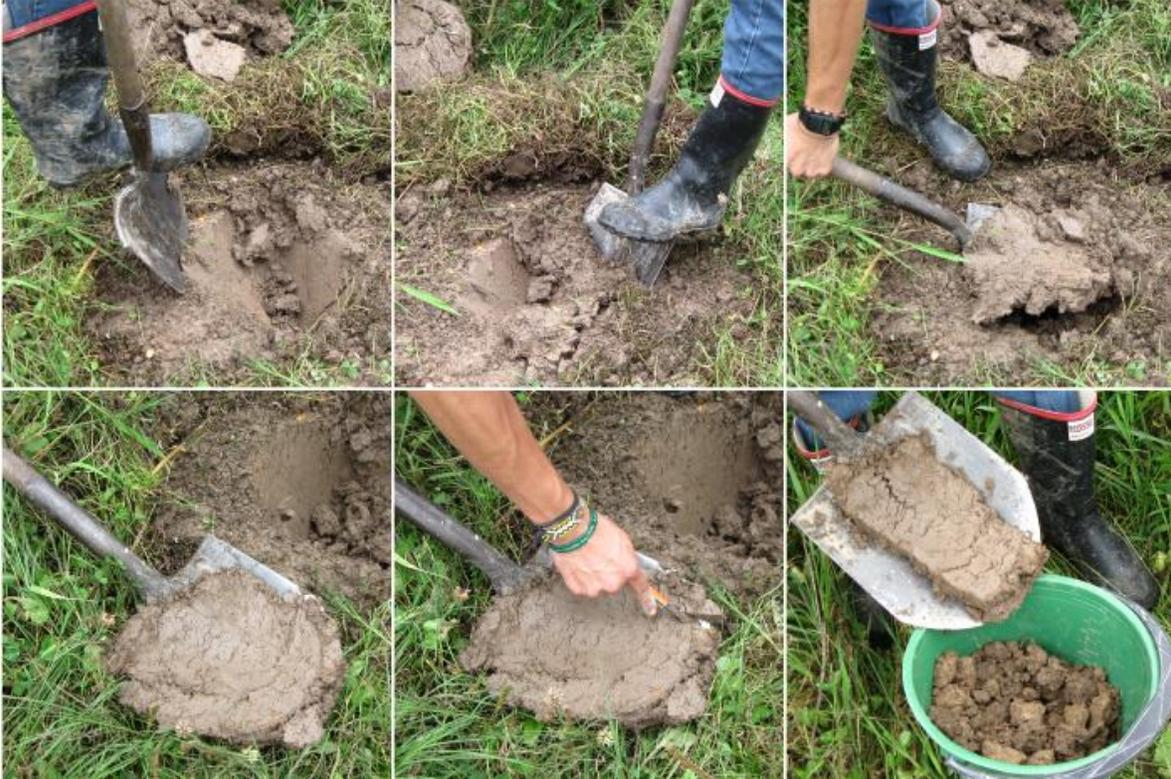
Con la ayuda de una pala, de preferencia plana y rectangular, realizar un hoyo de 20cm \* 20cm, luego realizar un corte vertical de uno de los lados para (como se muestra en la imagen inferior izquierda) mezclarla y tomar una muestra.
