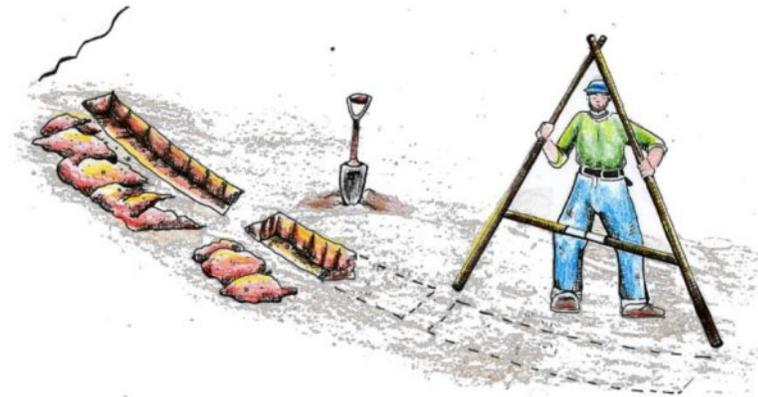
Las zanjas se deben construir de manera perpendicular a la dirección de la pendiente. Es por este motivo que, sobre las líneas de las curvas de nivel antes trazadas, se deben marcar ahora la ubicación de las zanjas. Esto considerando el largo y ancho propuesto para las zanjas en este predio, así como la distancia entre ellas, que en este caso deberá ser de 70 cm (Oyanedel et al., 2018).
